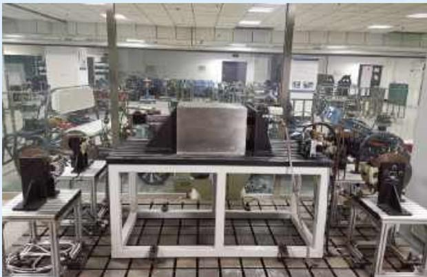
制动系统硬件在环实验台
