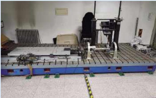
转向系统硬件在环实验台
