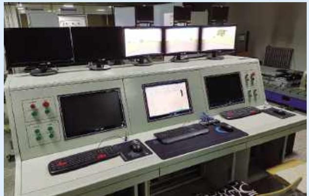
汽车硬件在环实验台控制台
