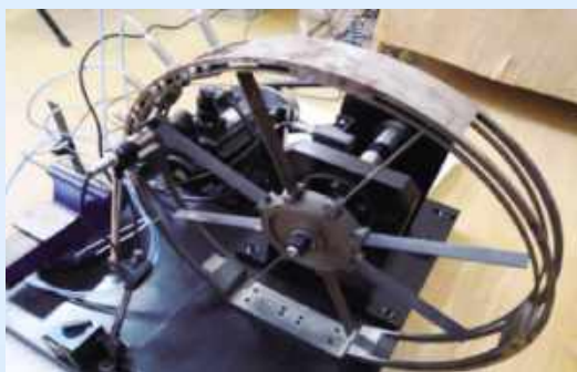
旋转叶片振动非接触测量装置
